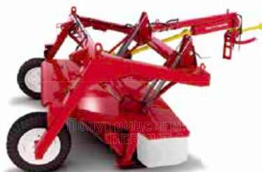
Полуприцепная косилка BERKUT 3200 рабочая скорость 15 км/ч, ширина захвата 3,2 м, производительность 5,2 га/ч.
