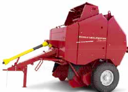
Пресс-подборщик рулонный PELIKAN 1200 ширина захвата 1,45 м, производительность до 10 т/ч, диаметр рулона 1,2 м
