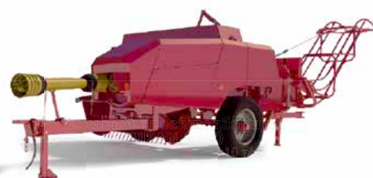
Тюковый пресс-подборщик TUKAN 1600 производительность до 10 т/ч, длина тюка до 1,3 м, вес тюка сена до 50 кг
