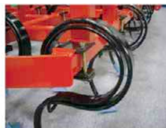
Комплектование стоек 45x12 усилителями
