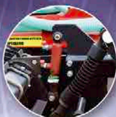
Гидравлическая регулировка давления на секцию сошников. Хорошее дополнение к ручной регулировке!
