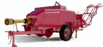
Тюковый пресс-подборщик TUKAN 1600 производительность до 10 т/ч, длина тюка до 1,3 м
