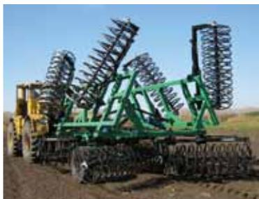
не разрезая их (в отличие от дисковых орудий), позволяя перейти на безгербицидную технологию. Выравнивает поверхность поля, создавая мульчирующий влагосберегающий слой, обеспечивает высокую устойчивость почвы к ветровой и водной эрозии.
