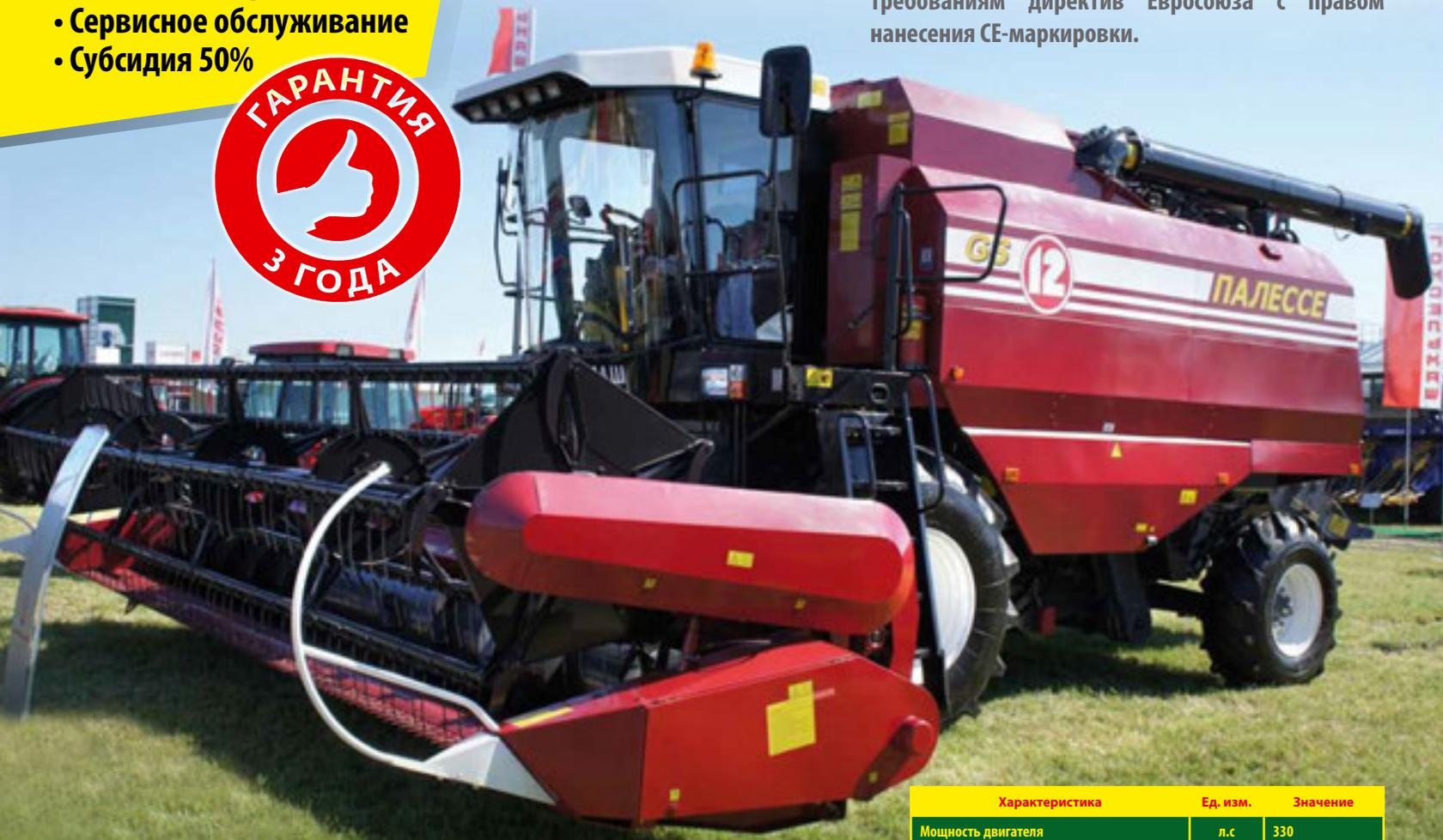
• Высокопроизводительный комбайн эффективно работает в широком диапазоне урожайности зерновых культур. Хорошо приспособлен для работы в неблагоприятных условиях на уборке труднообмолачиваемых культур повышенной влажности.
