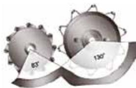
Отличительной особенностью молотилки «ПАЛЕССЕ GS12» являются увеличенные диаметры барабана-ускорителя и молотильного барабана: соответственно 600 и 800 мм. Результат – высокий уровень вымолота и сепарации, в том числе на высокостебельных культурах.
