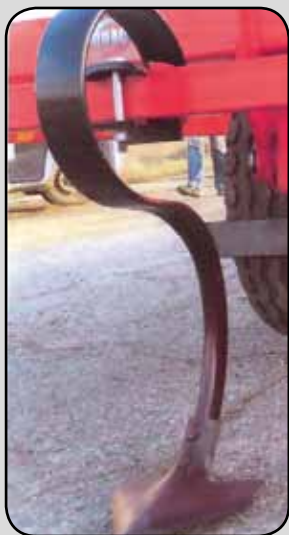
Лапа стрельчатая 230 мм Стойка 65 мм
