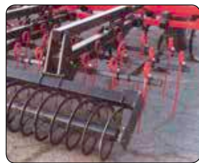
Спиральный шлейф-каток и унифицированные пружинные боронки
